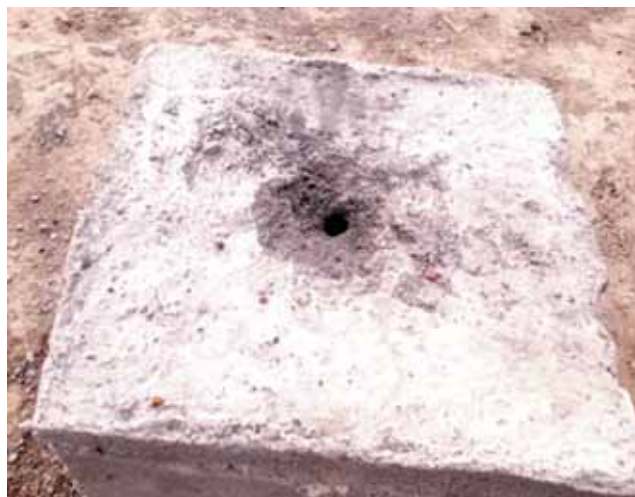
▲ Рис. 10. Бетонный блок после сгорания газогенераторного состава: \text{NaNO}_3 - 60\% , \text{Mg} - 20\% , \text{C} - 20\% ▲ Fig. 10. Concrete block after combustion of gas generator composition: \text{NaNO}_3 - 60\% , \text{Mg} - 20\% , \text{C} - 20\%
